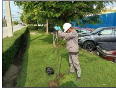
รูปที่ 4.22 การเก็บตัวอย่างดิน บริเวณระบบบำบัดน้ำเสียทางชีวภาพ แห่งที่ 1 (S2)
